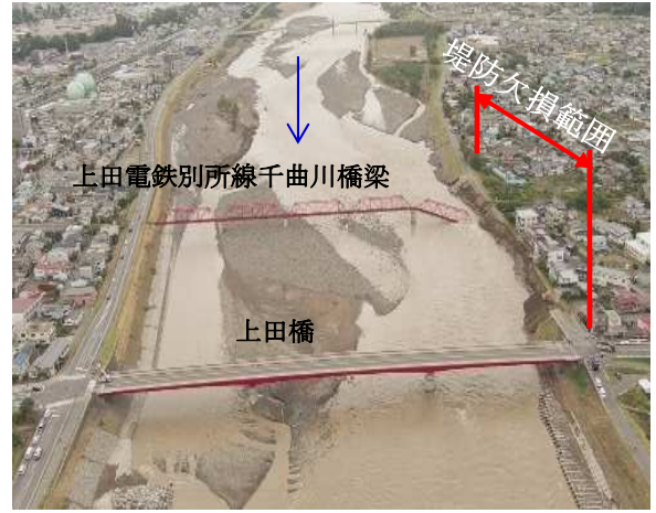
令和元年東日本台風時の千曲川洗掘状況
