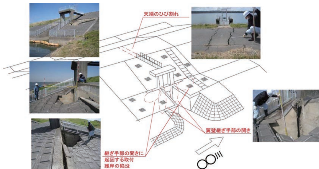
図1：樋門周辺部の被災状況
