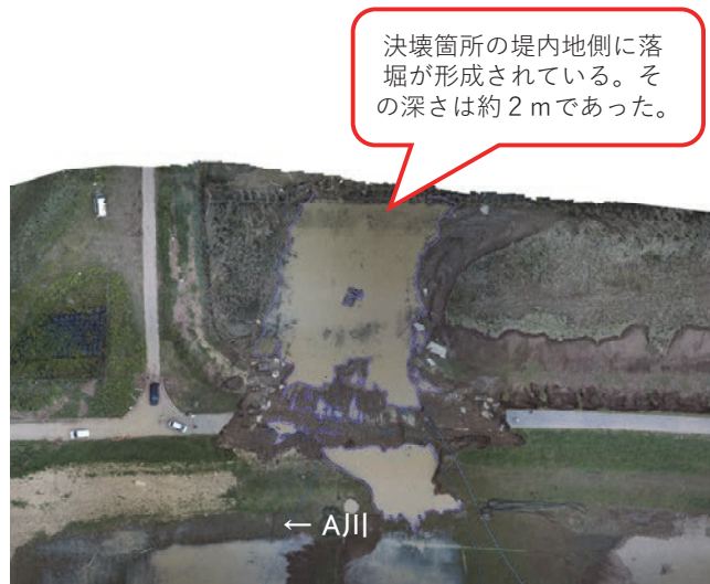
図－2 A川右岸0.0k付近の決壊箇所の状況
